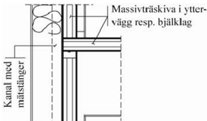
Kuva 11. Växjön puukerrostalon välipohjaliitos ja painuman mittauskanava.
