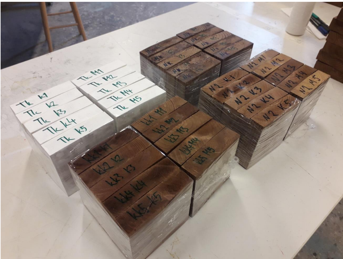
Kuva 20. Palonsuoja-aineella käsiteltyjä ISO 5660-1 kartiokalorimetri koekappaleita.
