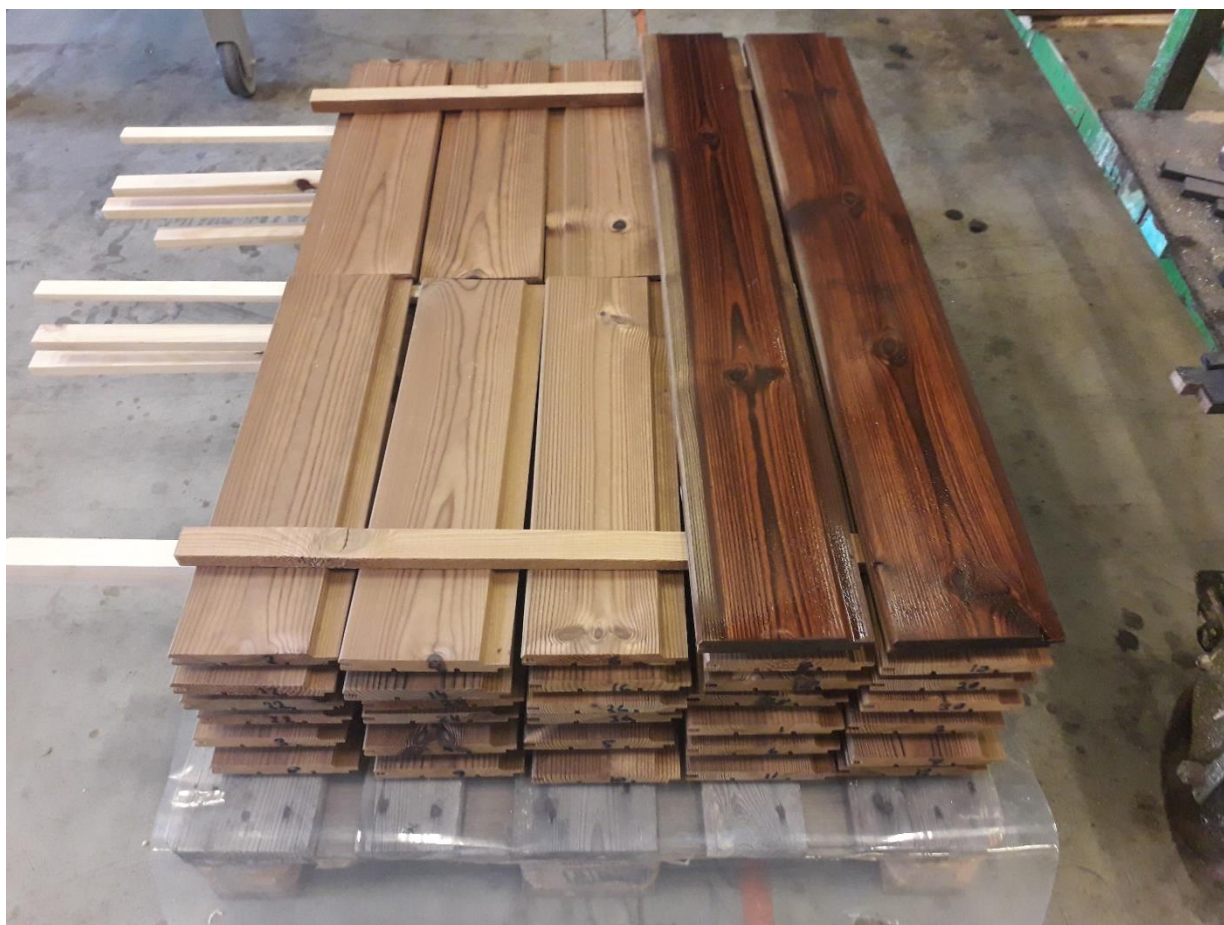
Kuva 12. Palonsuoja-aineella kyllästettyä Thermo-D mäntyä. Nipun oikeassa reunassa koemateriaalia kyllästykseen jälkeen märkänä ja alemmassa rimavälissä vuorokauden kuivumisen jälkeen.
