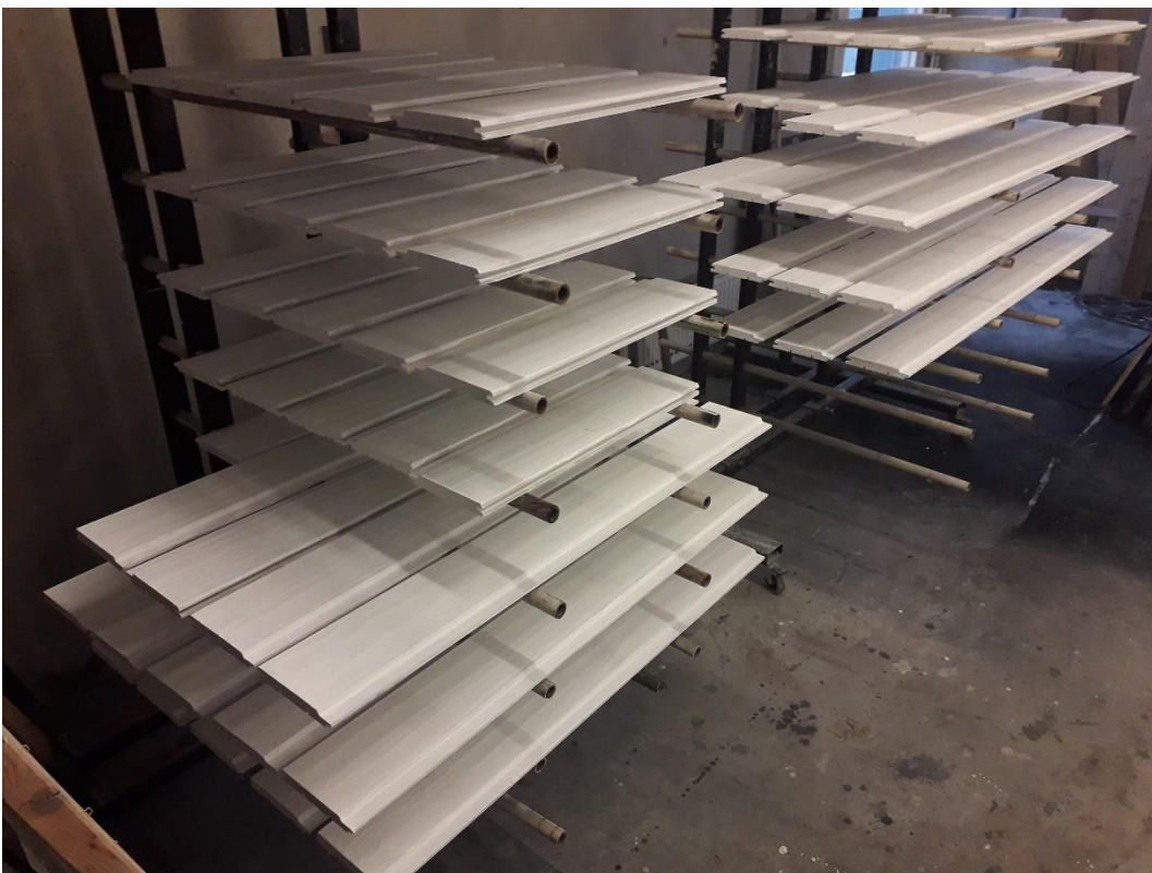
Kuva 17. Palonsuojamaalilla maalattua koemateriaalia kuivumassa maalaamossa.
