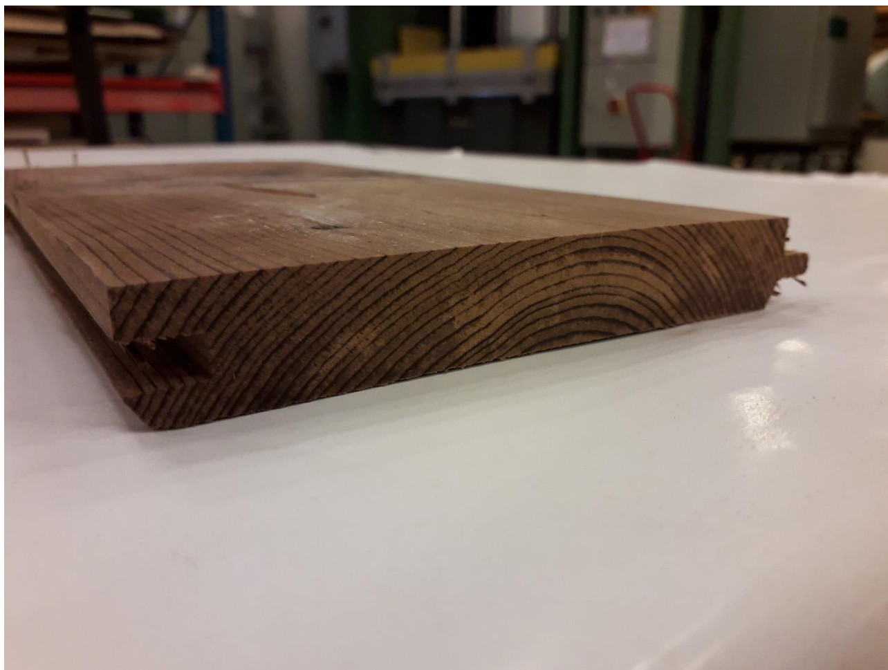
Kuva 14. Tunkeuman tarkastelu katkaisupinnalta koekappaleen kuivuttua (Thermo-D kuusi/TGV). Katkaisupinnalta nähdään, että koekappaleessa on keskellä vain muutaman millimetrin levyinen kylästymätön kohta. Kuvassa olevan koekappaleen retentio on ollut 530 \text{ kg/m}^3 .
