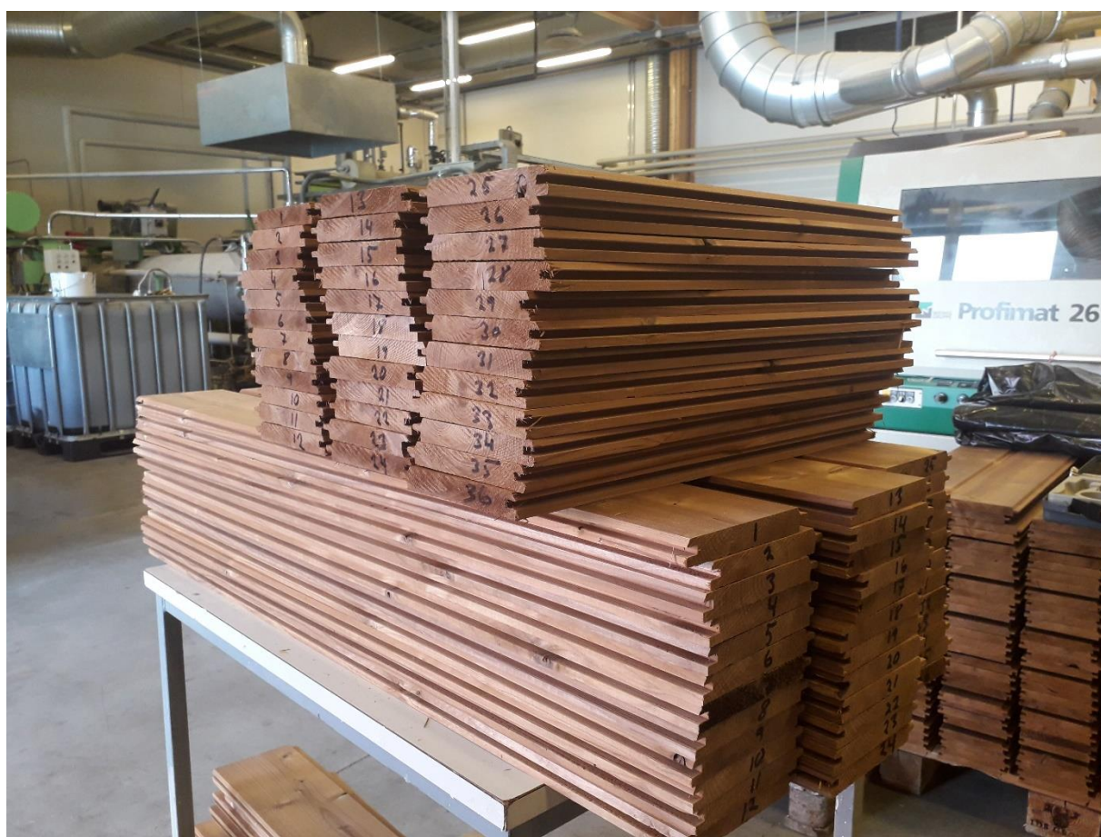
Kuva 11. Thermo-D kuusi koemateriaalia SBI vaaka-asennettavaan nurkkaan ennen käsittelyä.
