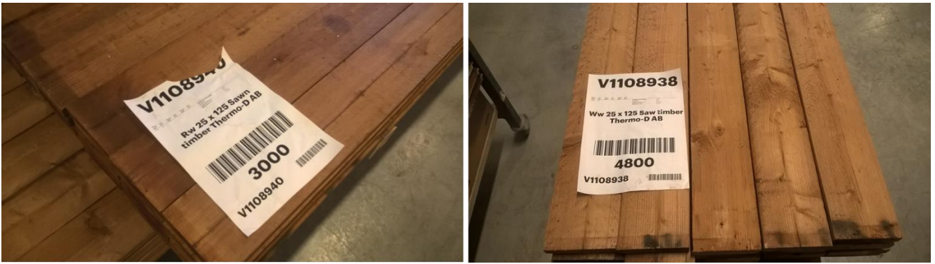
Kuva 1. ThermoWood koemateriaalia. 25mm x 125 mm Thermo-D mänty (pakettinnumero: V1108940) ja Thermo-D kuusi (pakettinnumero: V1108938).
