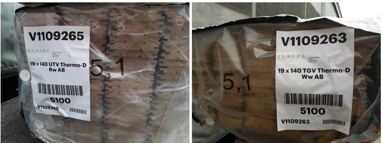
Kuva 2. ThermoWood koemateriaalia. 19 mm x 140 mm UTV Thermo-D mänty (pakettinnumero: V1109265) ja 19 mm x 140 mm TGV Thermo-D kuusi (pakettinnumero: V1109263).
