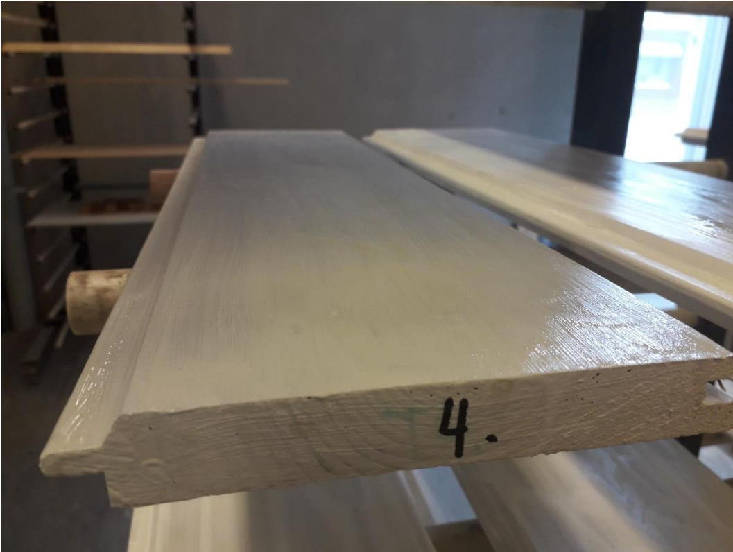
Kuva 16. Palonsuojamaalilla maalattua Thermo-D kuusta kuivumassa pintakäsittelyn jälkeen.
