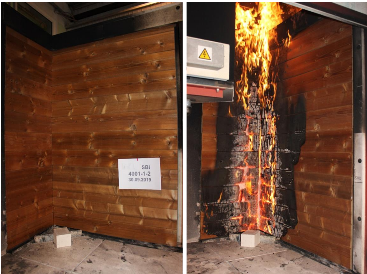
Kuva 23. Thermo-D kuusi / SBI vaaka-asennus (Horizontal). Luokka: D.
