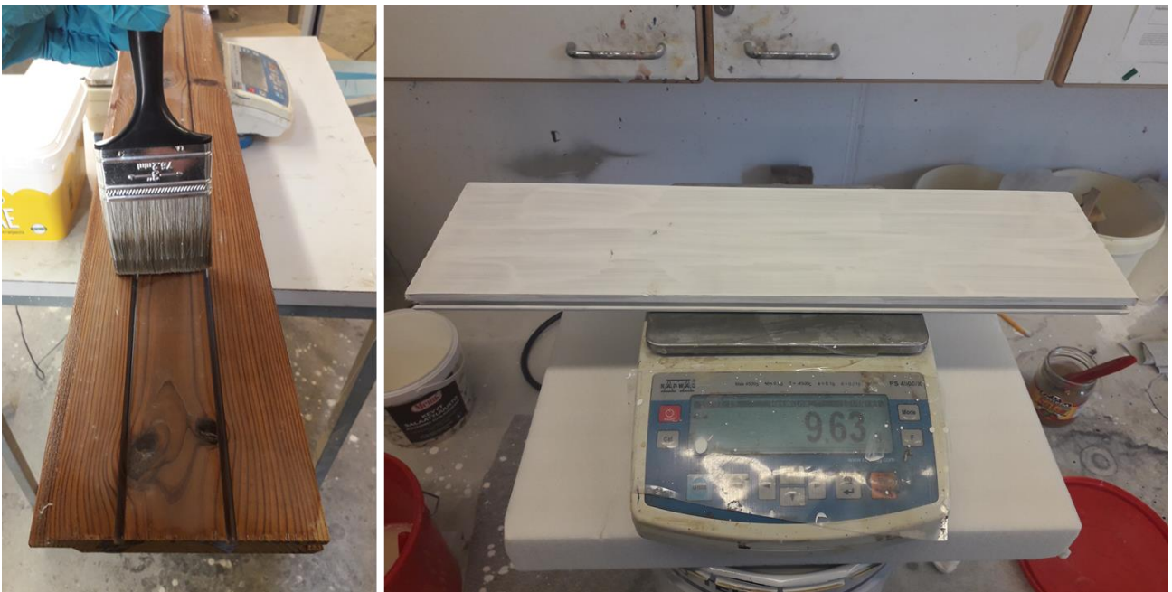
Kuva 7. Esimerkki kuvissa vasemmalla väritön palonsuoja-aine ja oikealla kalvon muodostava palonsuojamaali. Pintakäsittelyt sivelykäsittelynä.
