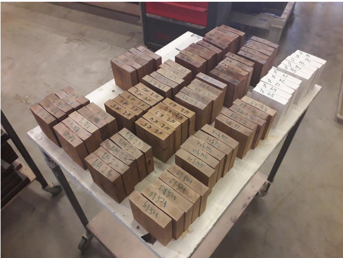
Kuva 21. Koekappaleita NT BUILD 504 hygroσκοoppisuuskokeeseen.
