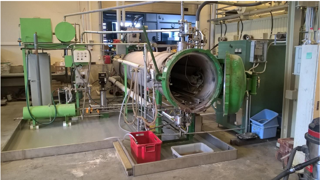
Kuva 6. Kaakkois-Suomen ammattikorkeakoulun (Xamk) puulaboratorion koekyllästyslaitteisto. Sylinterin halkaisija 750 mm, koemateriaalin maksimi pituus on 4,3 m ja tilavuus tyhjänä 2050 litraa.
