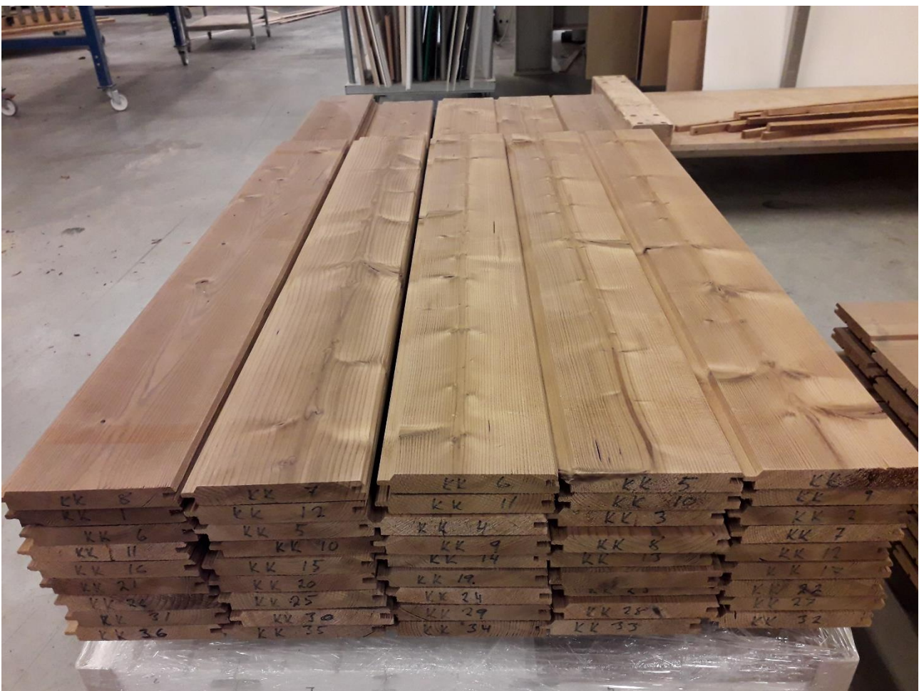
Kuva 18. Palonsuoja-aineella kyllästettyä Thermo-D kuusta. Ei havaittavissa jäämiä pinnoilta.
