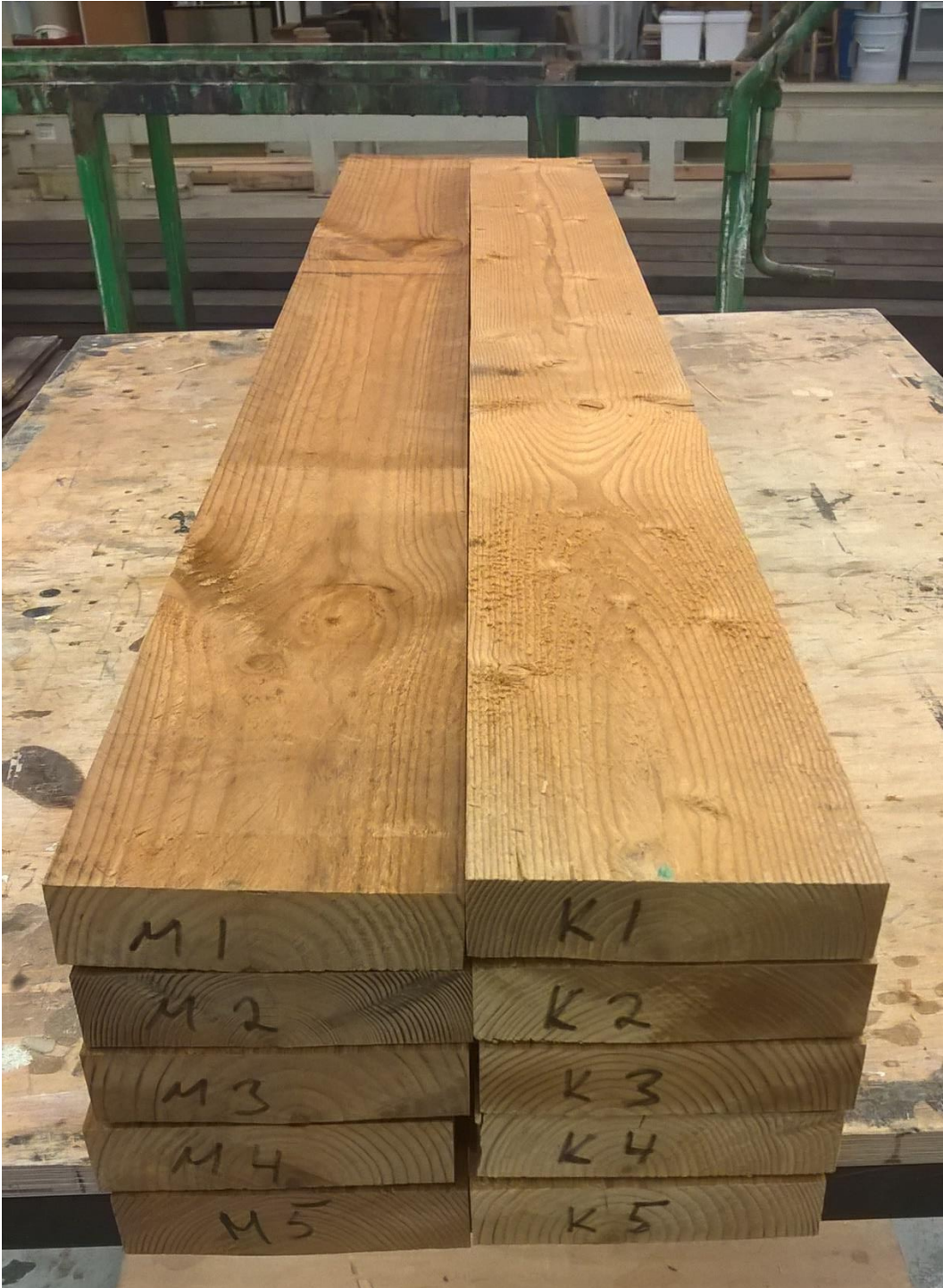
Kuva 8. Thermo-D mäntyä (M) sekä kuusta (K) sahattuna 1 m mittaiseksi koekappaleeksi ennen kyllästyskäsittelyä. Thermo-D männyn pakettista V1108940 ja Thermo-D kuuset pakettista V1108938.
