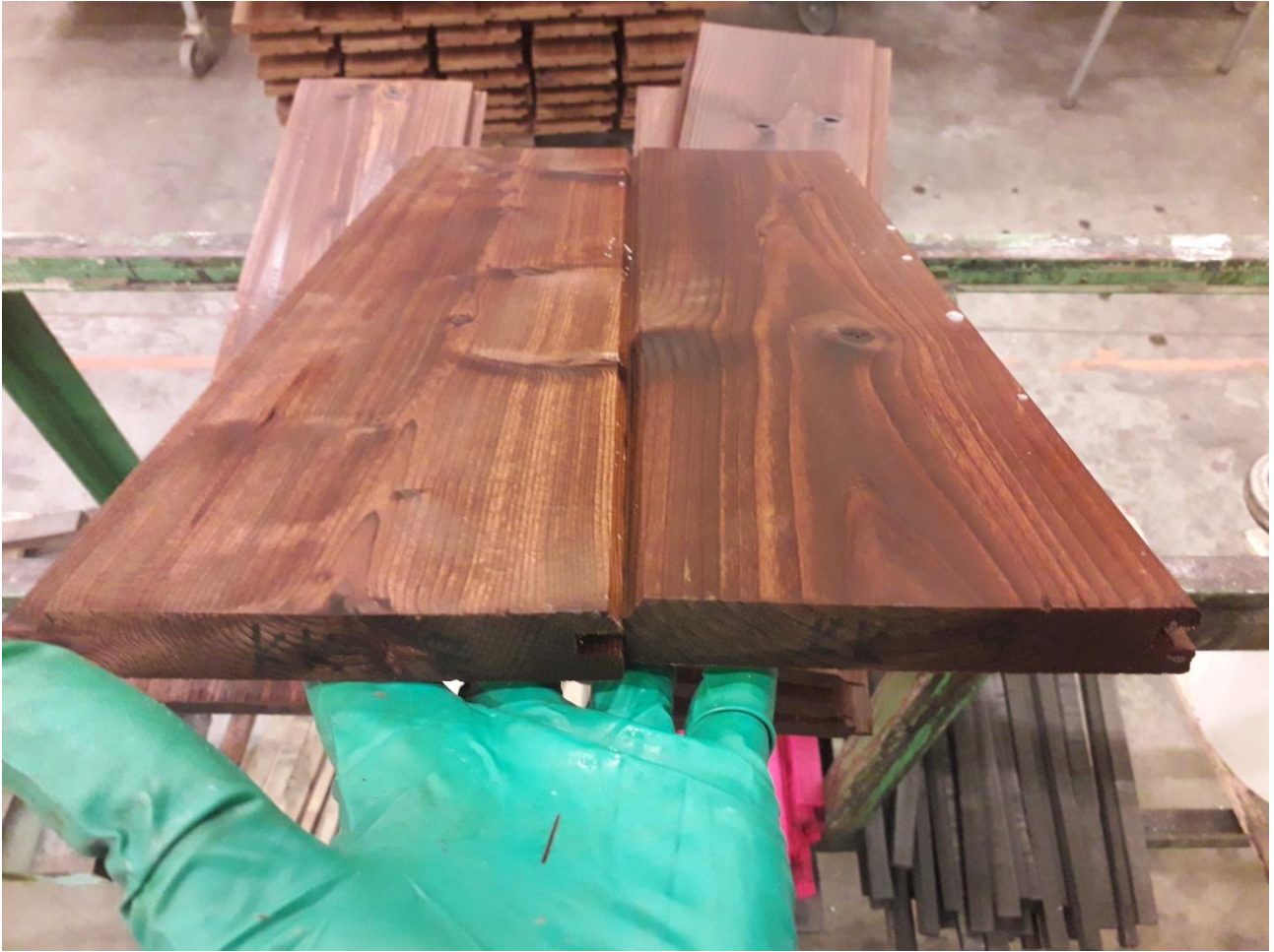
Kuva 15. Thermo-D kuusi TGV pontin sovitus heti kyllästyksen jälkeen. Sovituksissa ei esiintynyt ongelmia.
