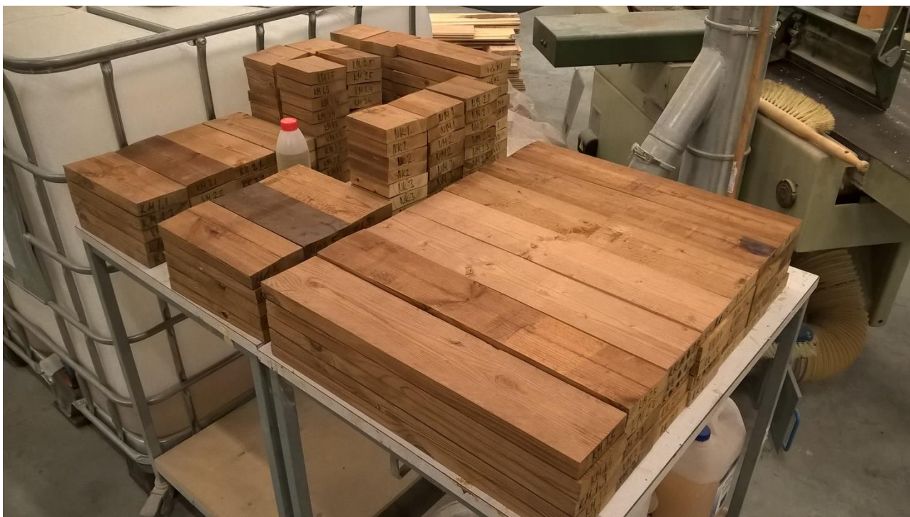
Kuva 9. Hankkeen koemateriaalia katkottuna jatkotesteihin. Thermo-D männyt paketista V1108940 ja Thermo-D kuuset paketista V1108938.
