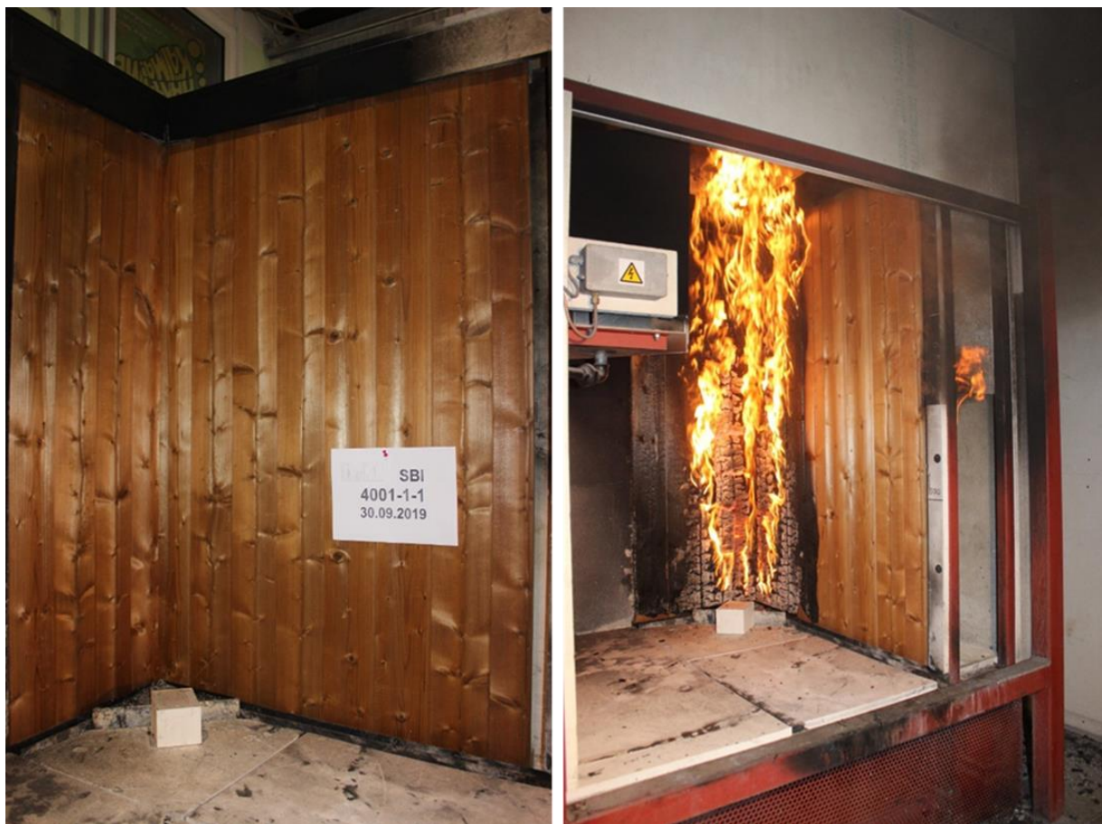
Kuva 24. Thermo-D kuusi / SBI pystyasennus (Vertical). Luokka: D.
