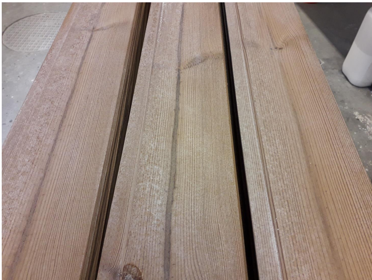
Kuva 19. Palonsuoja-aineella käsiteltyä Thermo-D mäntyä. Havaittavissa pieniä jäämiä pinnoilta.
