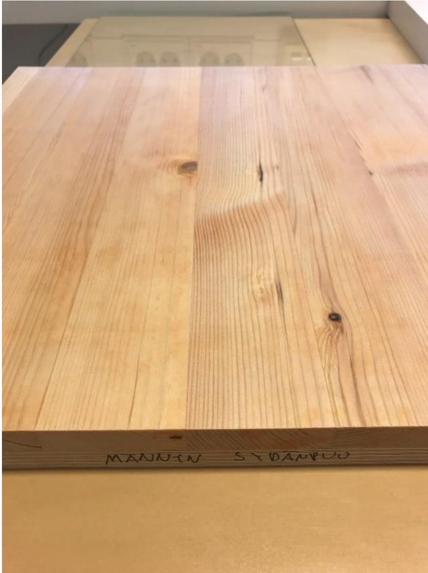
Kuva 18 Erityisesti männyn sydänpuun näytekappaleeseen lika tarttui tiukasti kiinni värjäten pintaa (kuva Juha Takkunen)
