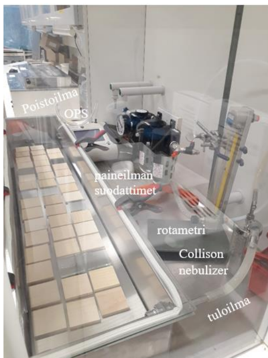
Kuva 4 Koejärjestely pintojen kontaminointia varten
