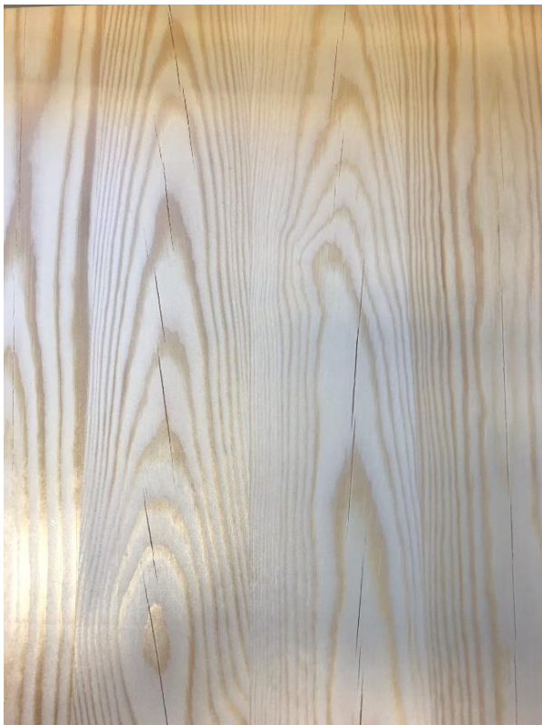
Kuva 6. Erityisesti pintakäsitelty mäntylevyt halkeilivat, kuvassa männyn vahalla käsitelty näyte kuvattuna 11.2.2020 ennen likaamista (kuva Juha Takkunen)
