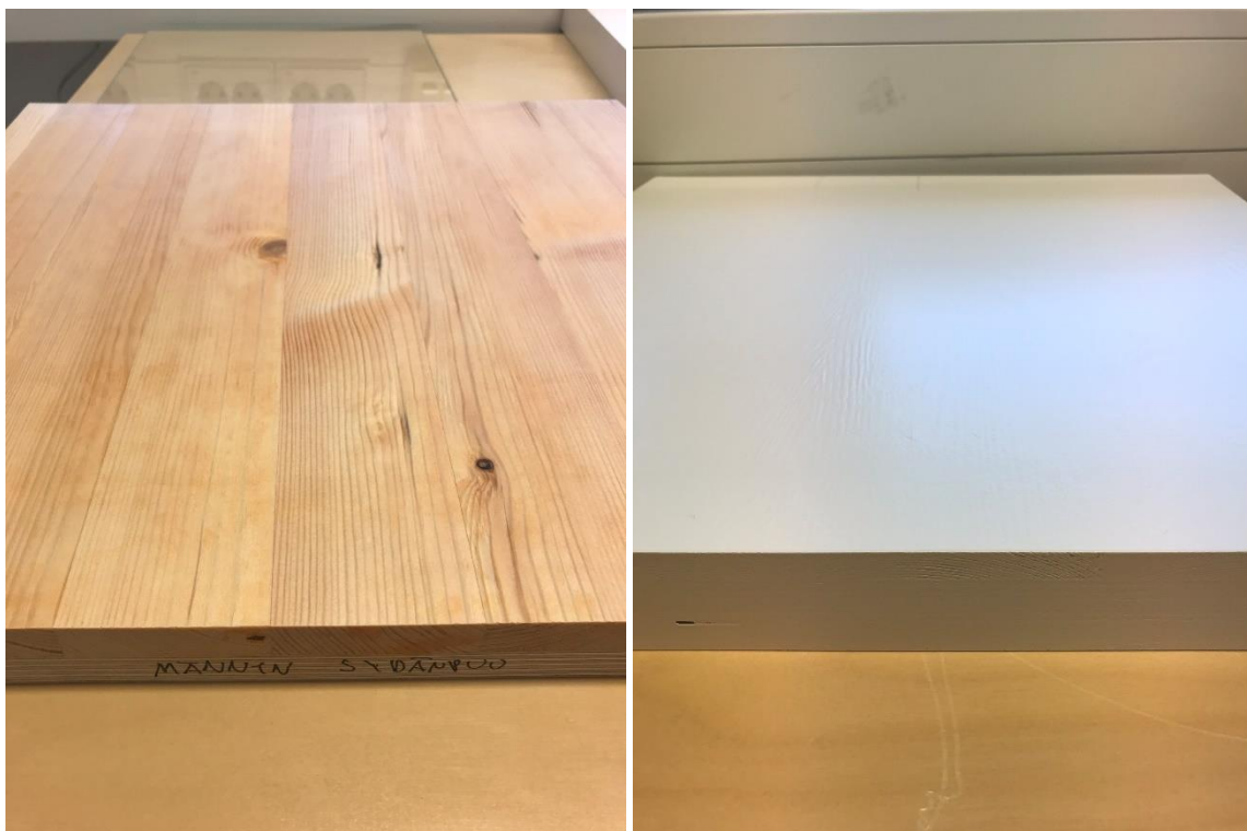
Kuva 9 Ensimmäisen likaamisen jälkeen männyn sydänpuun pinnassa on selkeää värjäymää – maalattu mäntylevy sen sijaan näyttää puhtaalta (kuvat Juha Takkunen)
