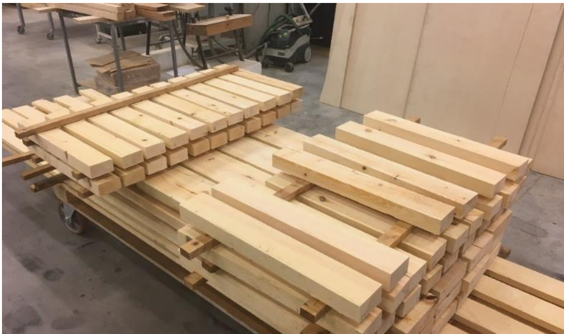
Kuva 2. Koemateriaaliaihioita valmistusprosessin aikana Xamk puulaboratoriossa
