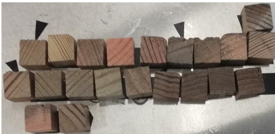
Kuva 1. Kyllästetyt puunäytteet kupari-, kromi- ja arseenipitoisuuksien selvittämiseksi EDS-mittauksilla.
