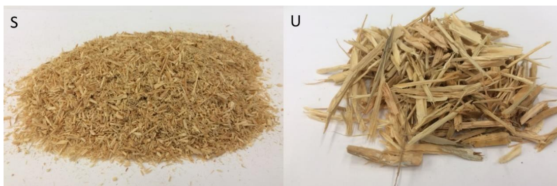
Kuva 3. Koekappaleissa käytetty puumurske; S: palakoko alle 4 mm, ja U: palakoko alle 10/20 mm.
