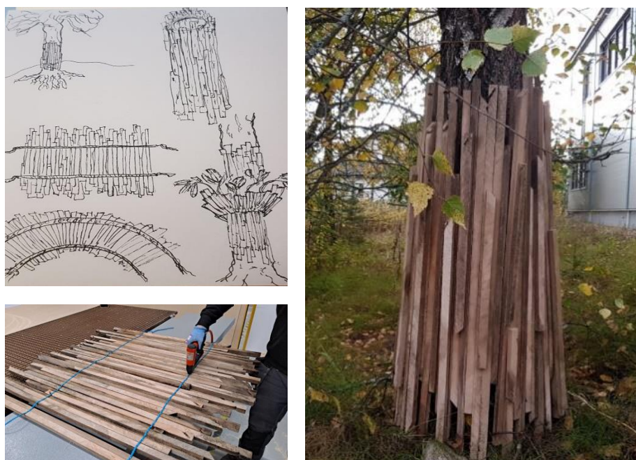
Kuva 13. Tuoteidea ja prototyyppi puunsuojasta, joka on valmistettu kierrätyspuusta. (Kuva: Tapio Tanskanen)
