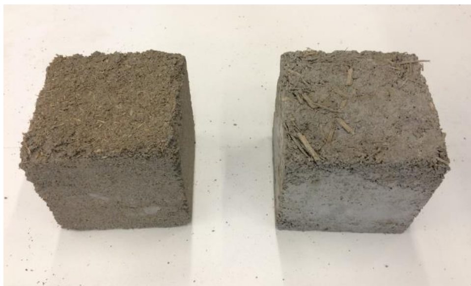
Kuva 4. Kierrätyspuuta sisältäviä koekuutioita puristuslujuuden määrittämiseksi.
