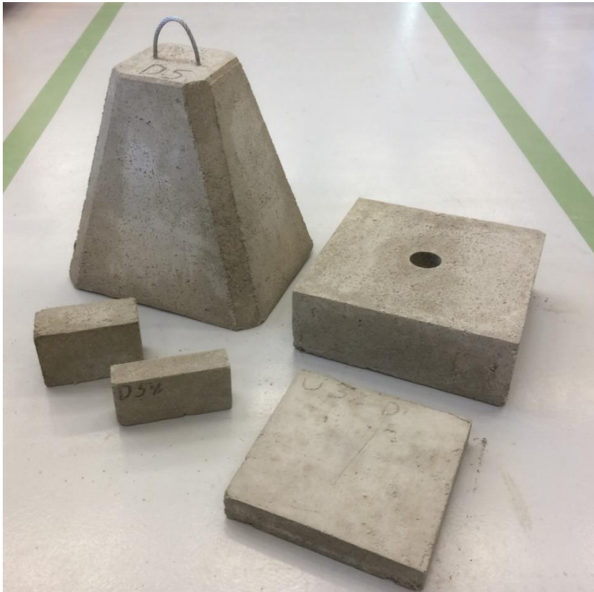
Kuva 7. Valmistettuja koetuotteita; pihakivet, pihalaatta, ajoeste ja liikennemerkkijalusta.
