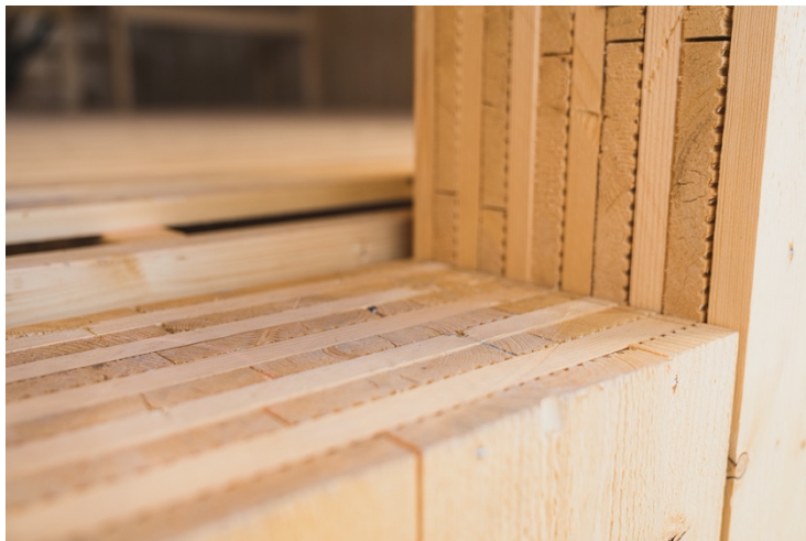
Kuva 15 Puurakentamisessa hyödynnetään uudenlaisia puuelementtejä. Kuvassa MHM-elementti, joka muodostuu ristiin päällekkäin alumiininauloilla kiinnitetyistä puukerroksista ja on liimaton ja muoviton
