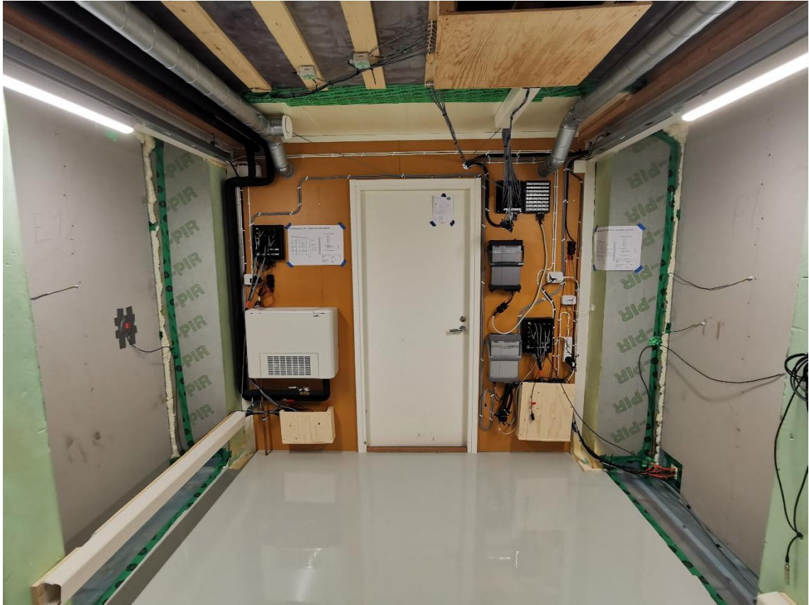
Kuva 17. Näkymä koerakennuksen tutkimushuoneesta, missä mittauksessa on kaksi kipsilevypintaista koe-elementtiä.
